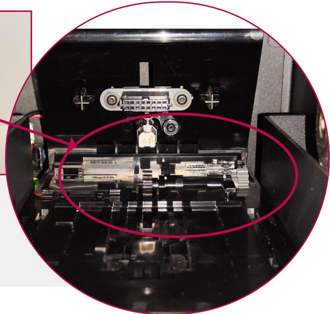
Der innere Bereich des Gehäuses (bei entnommenen Banknotenleser) ebenfalls mit einem TellerMate Microfasertuch reinigen. Bitte prüfen, dass der Bereich staubfrei ist und die Zahnräder erkennbar im guten Zustand sind.
