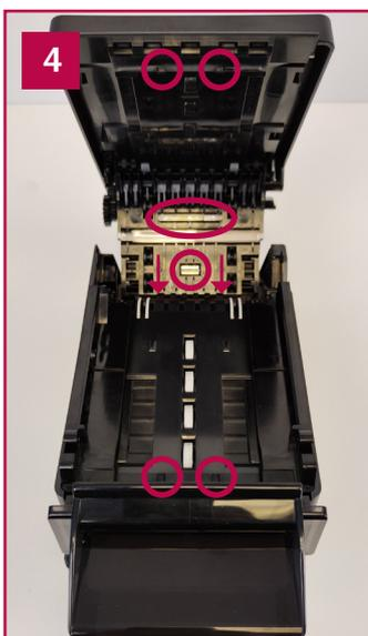
4 Mit einem sauberen Tellermate Microfasertuch die Sensoren und den Banknoteneinzug reinigen. **Unter keinen Umständen Öle oder andere Reinigungsprodukte verwenden!**
