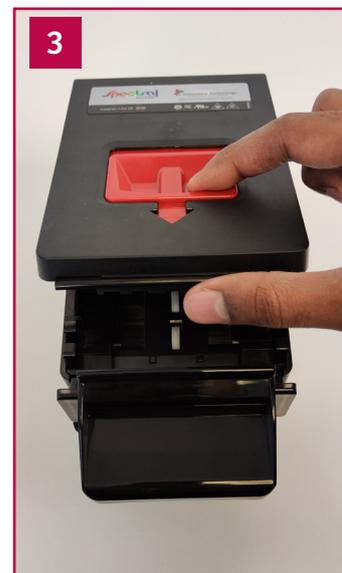
3 Um den Banknotenleser zu öffnen, die rote Verriegelung nach vorne ziehen und den Deckel nach oben klappen.
