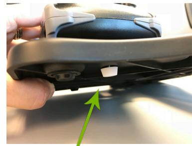
Nun können Sie die Touch so wie unten gezeigt auf die Halterung setzen. Sind die Haken auf der Rückseite in der richtigen Position? Setzen Sie nun die Touch vorsichtig ab. Setzen Sie die schwarze Schraube am Boden ein und drehen diese im Uhrzeigersinn fest.
